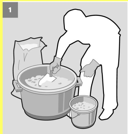
De verhouding cement/zand/grind voor beton is 1:2:3. Meng dus 1 deel cement, 2 delen zand en 3 delen grind. Een deel is bijvoorbeeld een schep, een emmer of een zak. De benodigde hoeveelheid schoon water is niet exact aan te geven, omdat die afhankelijk is van het soort cement, zand en grind dat je gebruikt.
